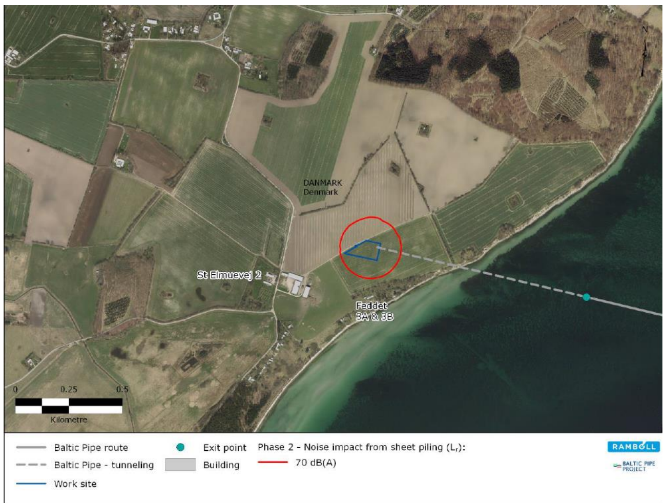
Figur 6-12 Støjkort der indikerer støjniveauet forbundet med ramning af pæle, ved etablering af arbejdsarealet for ilandføring af gasrørledningen ved Faxe Ladeplads. Den røde streg indikerer udstrækningen af 70 dB(A) støjniveauet (Rambøll 2018d).
