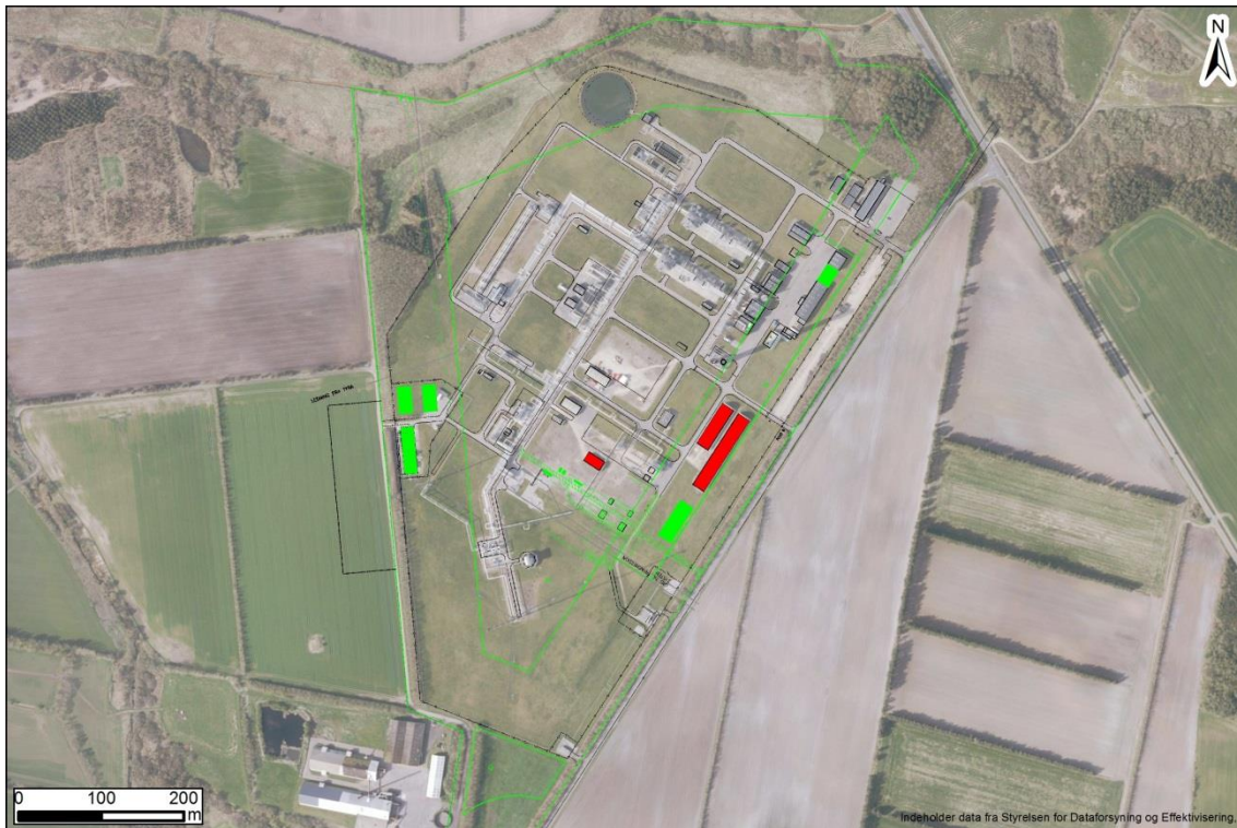
Figur 3-27 Placering af ny modtageterminal ved Nybro. (Nye anlæg er vist med grønt. Bygninger, der evt. fjernes eller flyttes, er vist med rødt)
