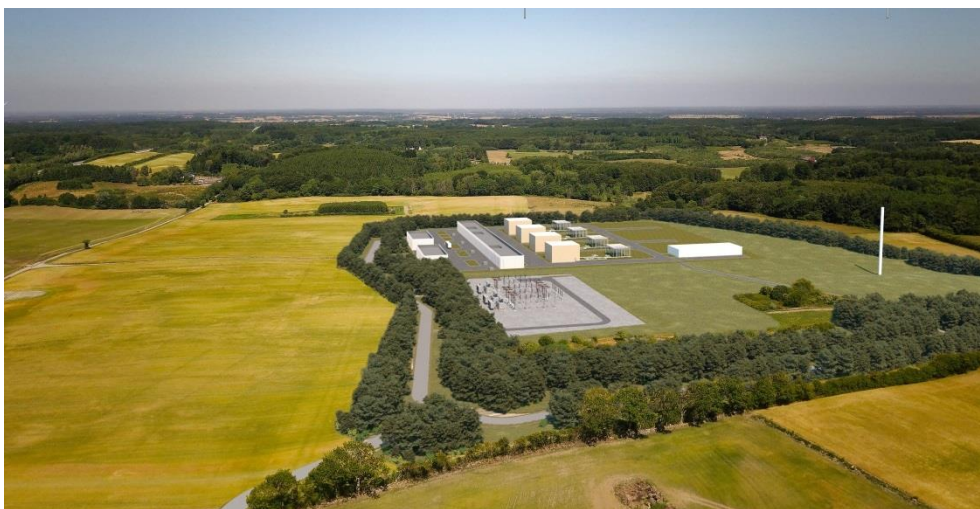
Figur 11-17 Dronepunkt B. Dronefoto med visualisering af det nye anlæg set fra syd mod nord over projektområdet. Skovbrynet til Tågeskov Hestehave ses i baggrunden. Det fremgår desuden, at der er friholdt et areal mellem den nye station og skoven for at bevare indblikket til skoven. På denne visualisering er vist eksempel på ny adgangsvej via Tågeskovvej nederst til venstre i billedet.
