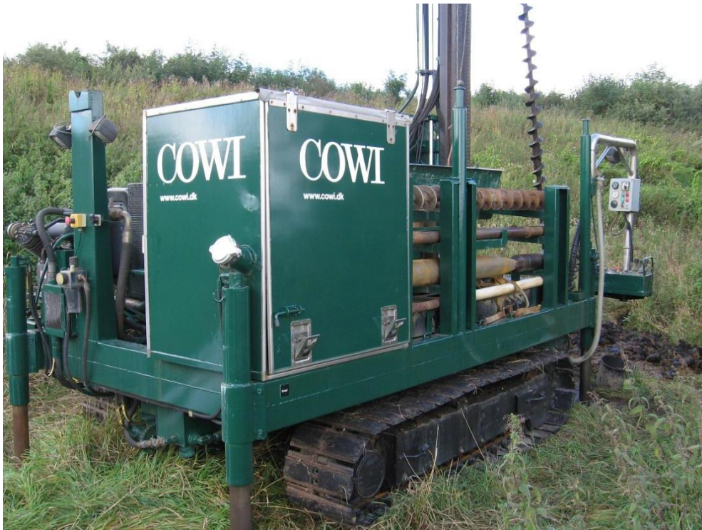
Figur 17-1 Eksempel på køretøj som udfører geotekniske boringer
