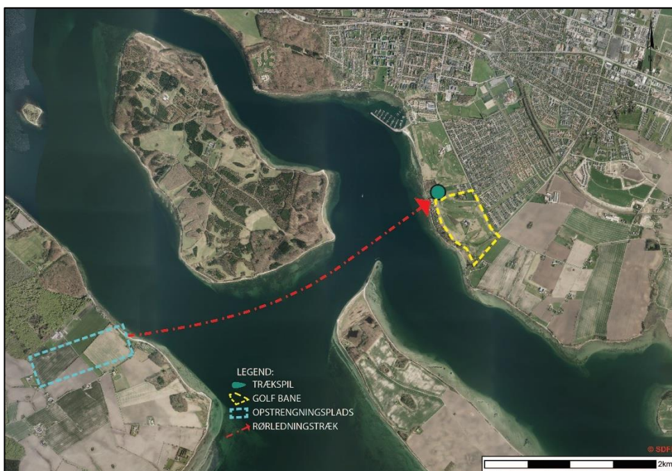
Figur 3-21 Linjeføring for gasrørledning under Lillebælt.
