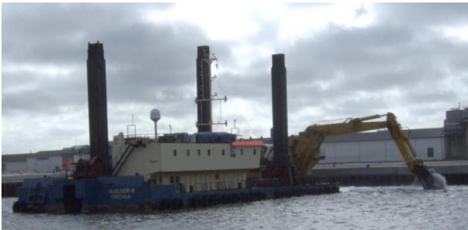
Figur 6-4 Her ses et eksempel på en back-hoe dredger, som er typen af fartøj, der er brugt til støjberegningerne.
