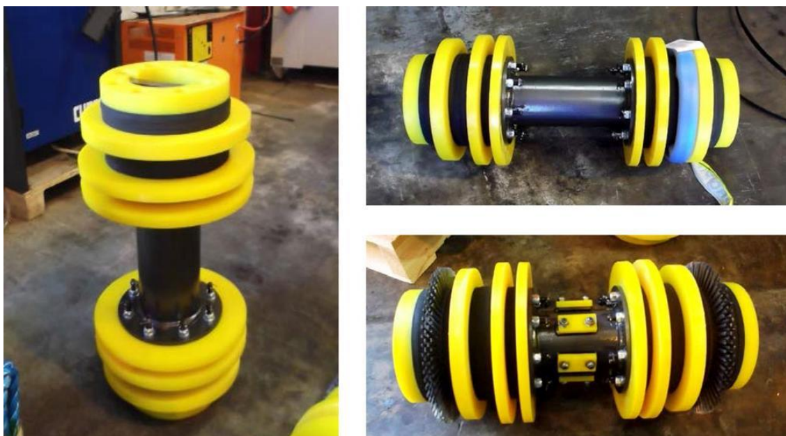
Figur 3-26 Eksempel på rengreiser, der sendes gennem gasrørledningen for at rense for eventuelle urenheder.
