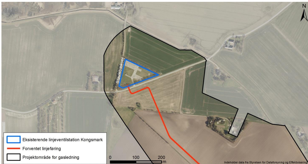
Figur 9-3 Byggezzone for udvidelse af linjeventilstationen ved Kongsmark. Det forventes, at der skal fældes enkelte træer i forbindelse med udvidelsen
