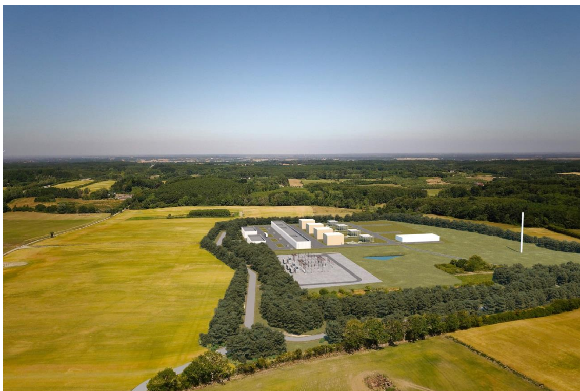
Figur 3-31 Visualisering af det overordnede layout af kompressorstationen med servicebygninger (til venstre), fire kompressor-enheder, rørføringer og afblæsningskorsten (til højre). Foretrukken adgang til området er fra Rønnedevej til højre (udenfor billedet). Adgang fra Hestehavevej vist nederst til venstre i billedet.
