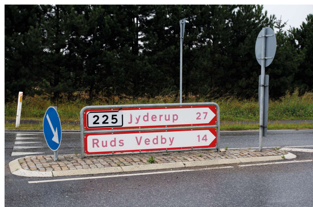
Vejviserskilt hvor dele af teksten er slidt af. Skiltet lever stadig op til tilstandskravet da teksten endnu er mulig at læse.
