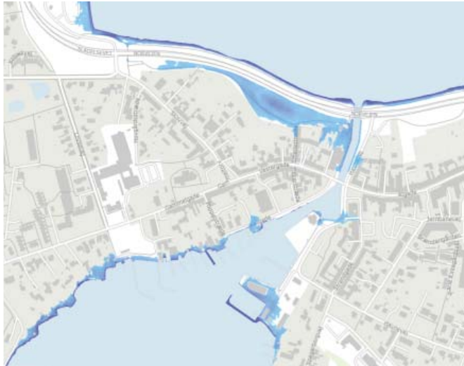
Oversvømmelser ved vandstand på +1,2 meter. (kilde: Slagelse Kommune)
