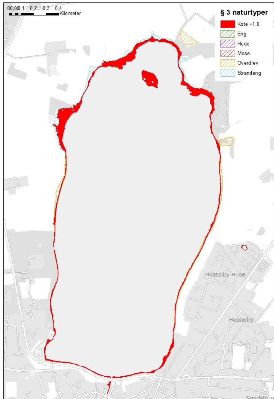
Figur 9-10 Kort, som illustrerer overlapsanalyse af § 3-arealer, der oversvømmes ved vandstand kote +1,0.
