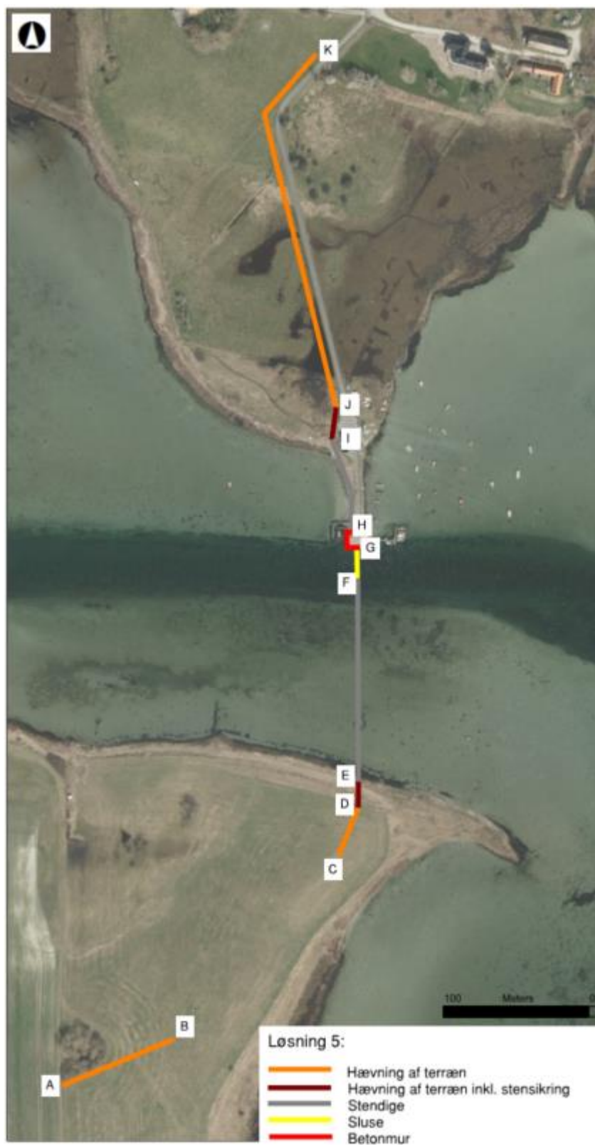
Figur 6-22 Princip for sikring af havnen – Løsning 5
