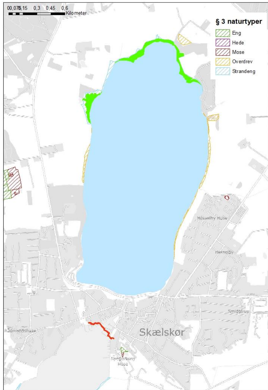
Figur 9-13 Kort over løsning 3 samt kortlagt habitatnatur og kortlagte § 3 arealer. Løsningen har få landbaserede sikringstiltag, men indeholder etableringen af en sluse/højvandsport i indløbet til havnen Natura 2000. Kortlagt strandeng (1330) er markeret grøn og kortlagt kystlagunde (1150) er markeret lyseblå.
