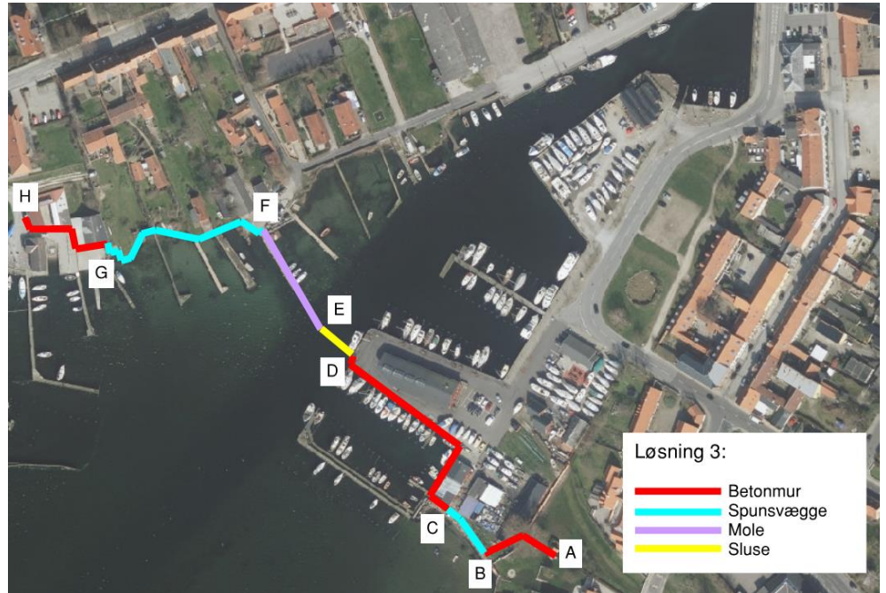
Figur 6-15 Princip for sikring af havnen – Løsning 3
