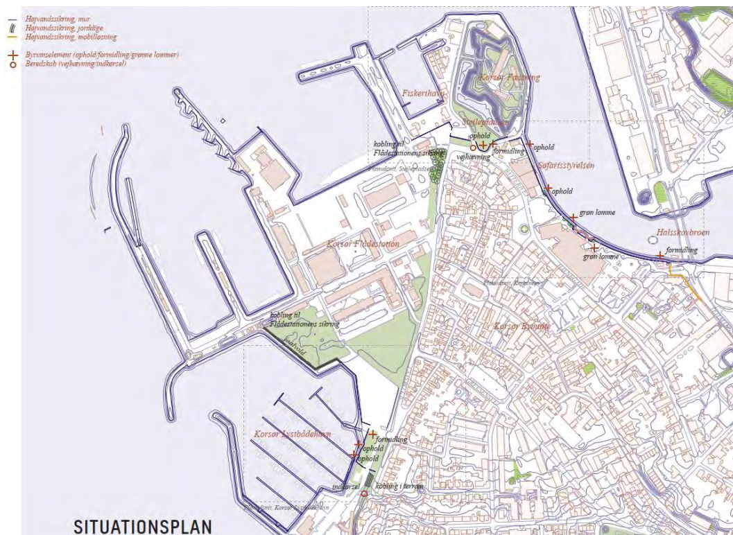
Figur 1-1: Linjeføring for højvands sikring af Korsør bymidte.
