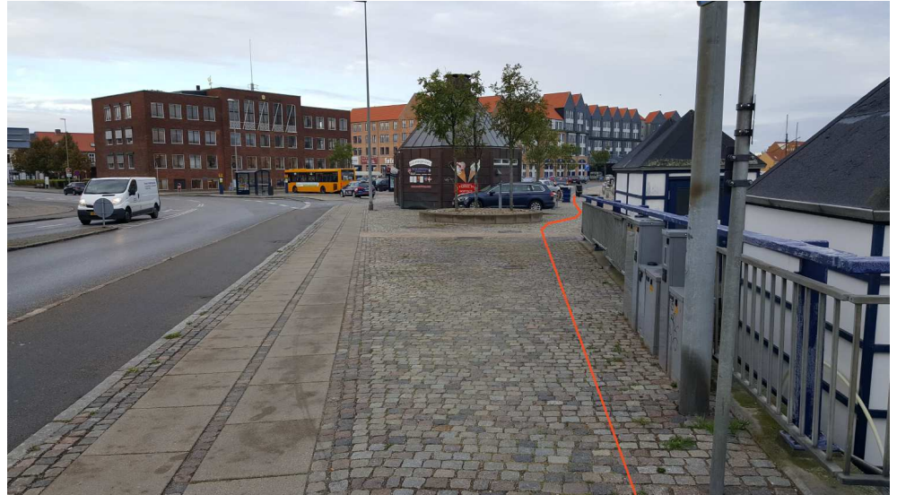
Figur 4-9 Skitseret linjeføring fra Halskovbroen videre langs kajkant v. Inderhavn. Tilbagetrukket til kantsten. Højvandsmur. (Strækning A-B).
