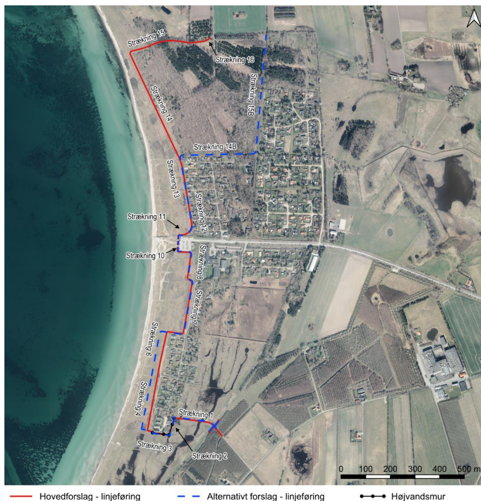
Figur 2-2 Oversigt over hovedforslagets og det alternative forslags linjeføring ved Kobæk Strand.
