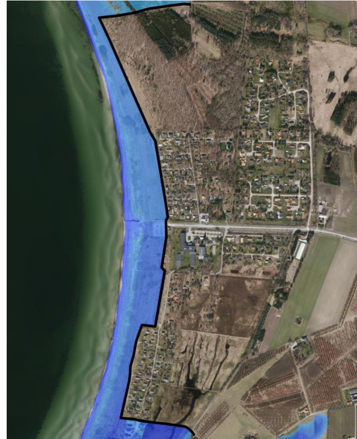
Højt vandshændelse med dige kote 1.90
