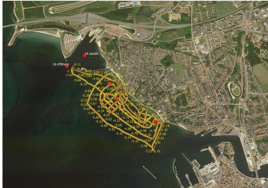
Figur 2.5: Punkter med opmålte dybde, single beam opmåling NIRAS 2019.
