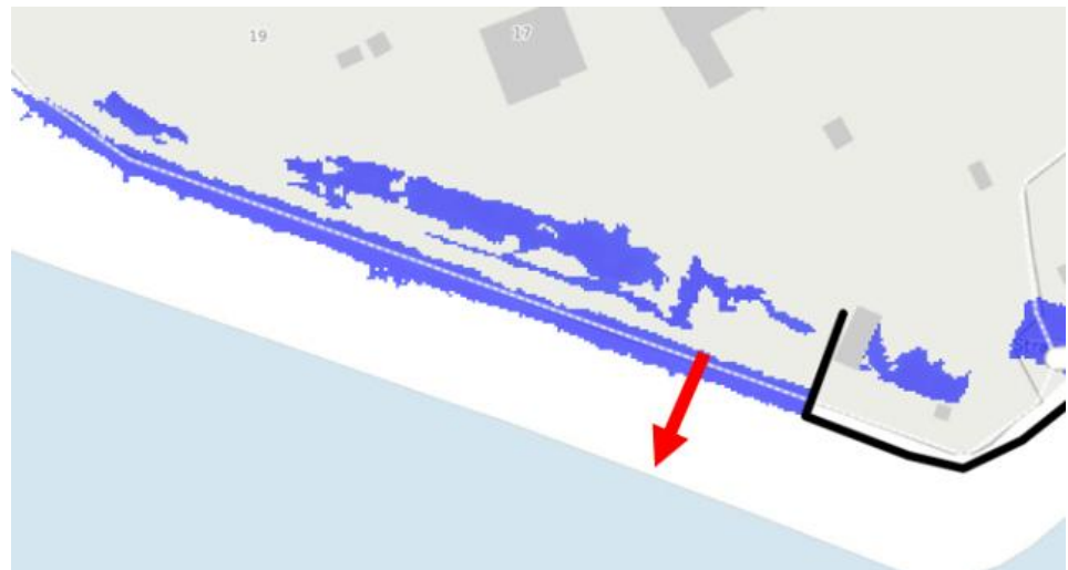
Figur 4.1: Område 3: ophobning af vand på asfaltstien vest for diget.
