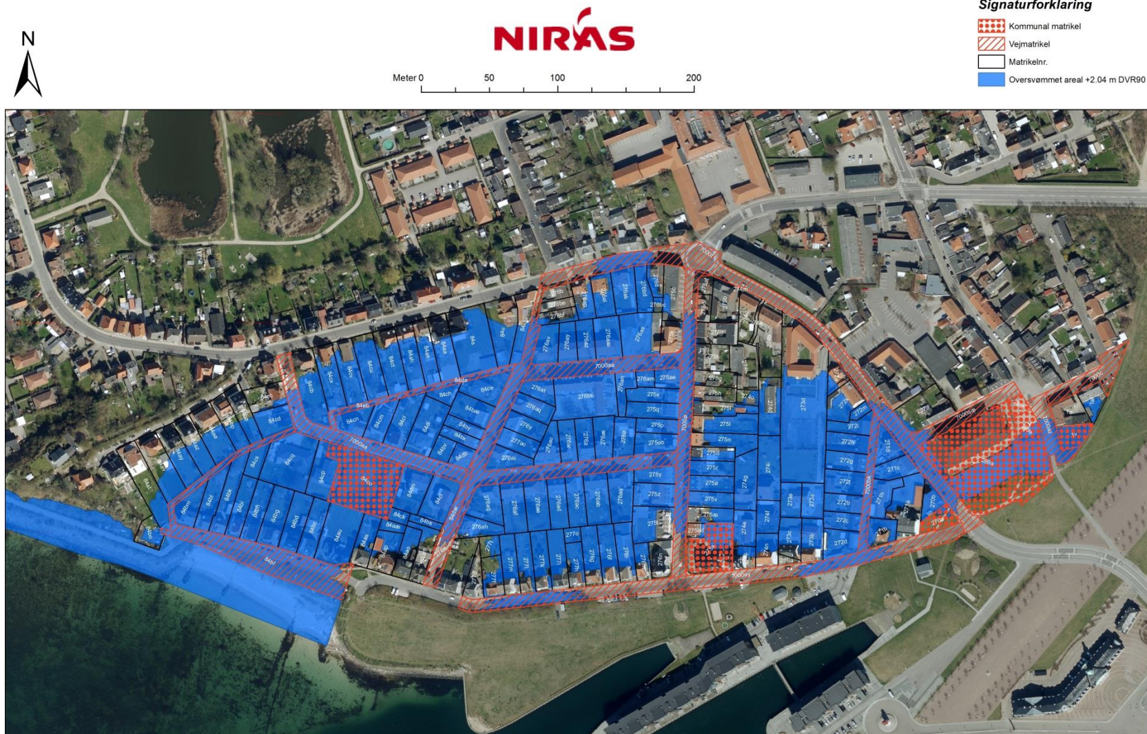
Figur 4-1 Oversvømmet område i dag i område 3 for en 100 års højvandsændelse med 25 cm klimatilpasning.
