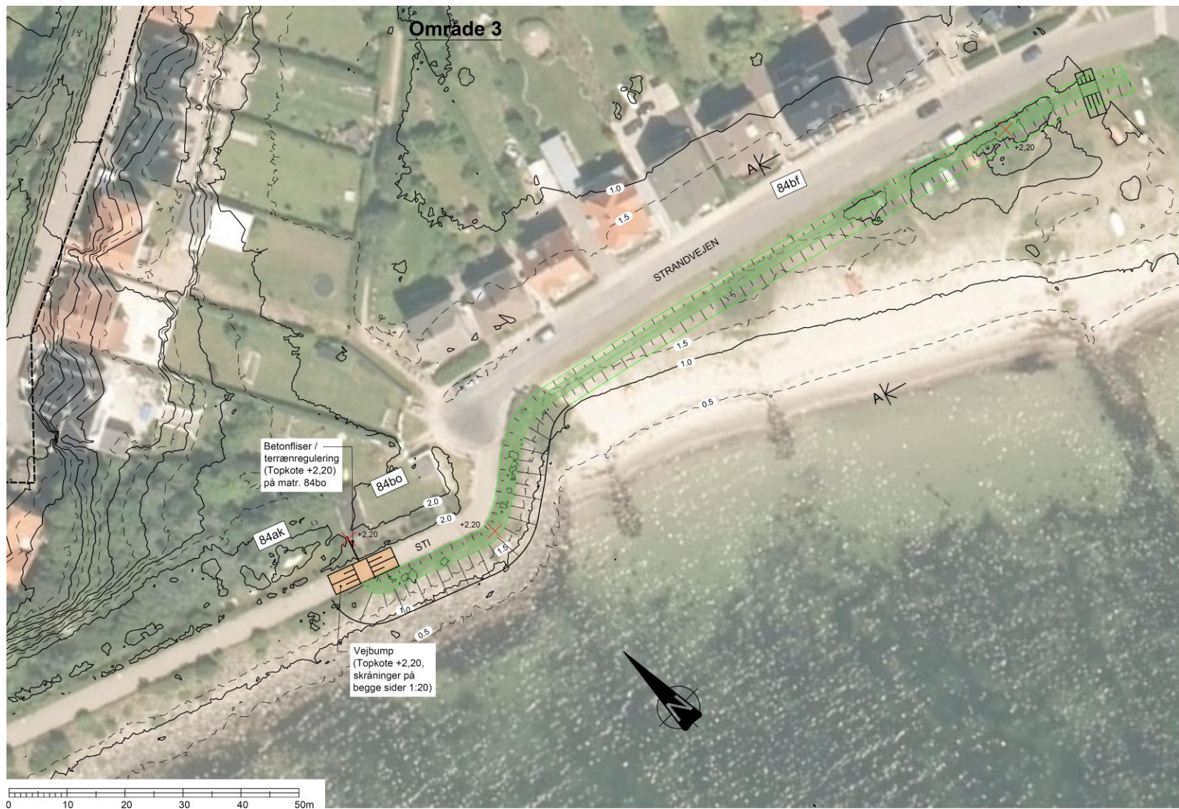
Figur 3.1: Plan af højvandsbeskyttelse, se Tegning C3_103 og C3_113, som er bilagt Notat.
