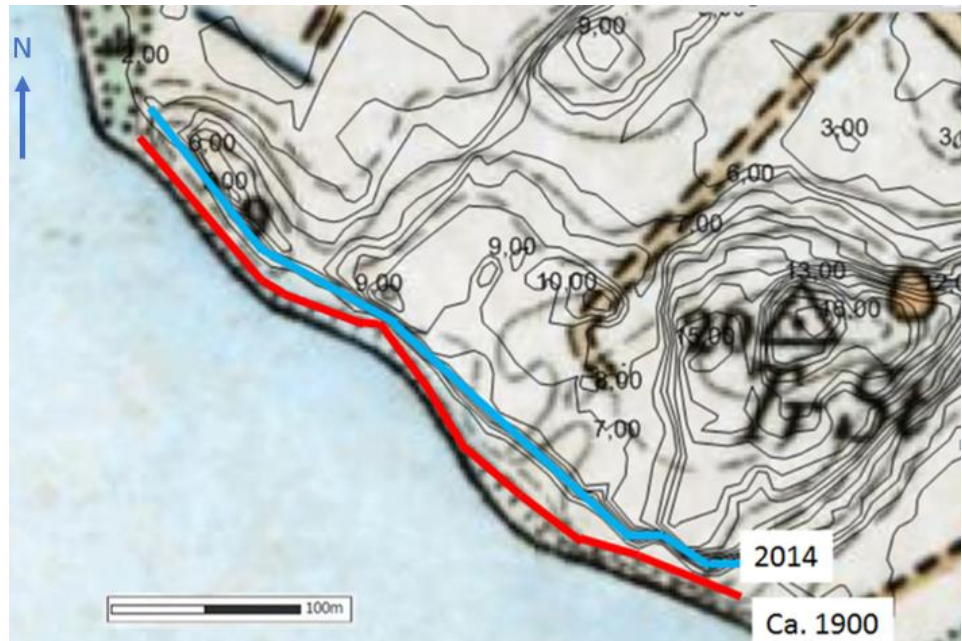
Figur 2.4: Udvikling af klinten de sidste 90 år. Der er i alt eroderet ca. 640 m 3 materiale per år, hvoraf 50 % anses for at være sand, grus og ler som bliver i den aktive kystzone, mens silt- og lerfraktionen forsvinder væk fra kysten med strømmen.
