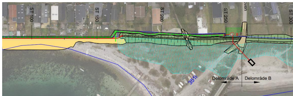
Figur 3-10: Planlagt afværgeforanstaltning for ekstremregn vandopland syd.
