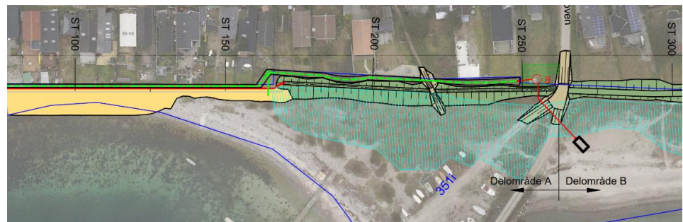
Figur 3-10: Planlagt afværgeforanstaltning for ekstremregn vandopland syd.
