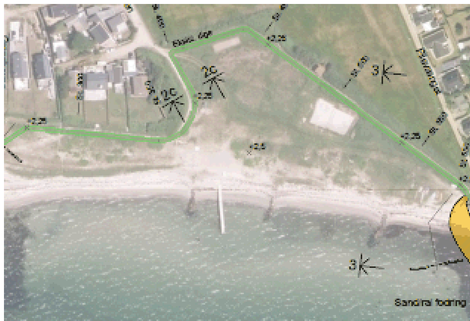
Figur 2.12 Forstærkning af eksisterende jorddige i Delområde B. Tegning C3_105 B
