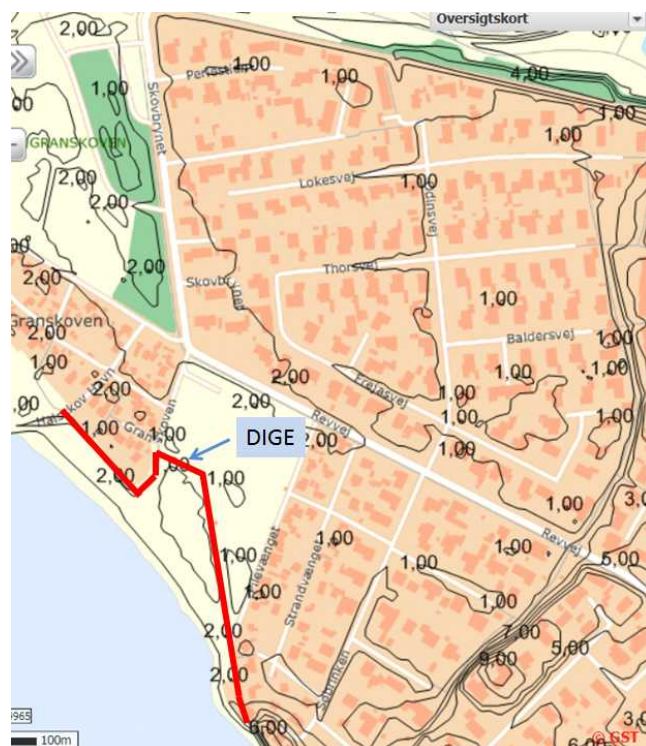
Figur 2.10. Koter (DVR90) i Delområde B i digeområde 1. På nær et mindre område ligger hele området under den valgte sikringskote på +2,06 m.
