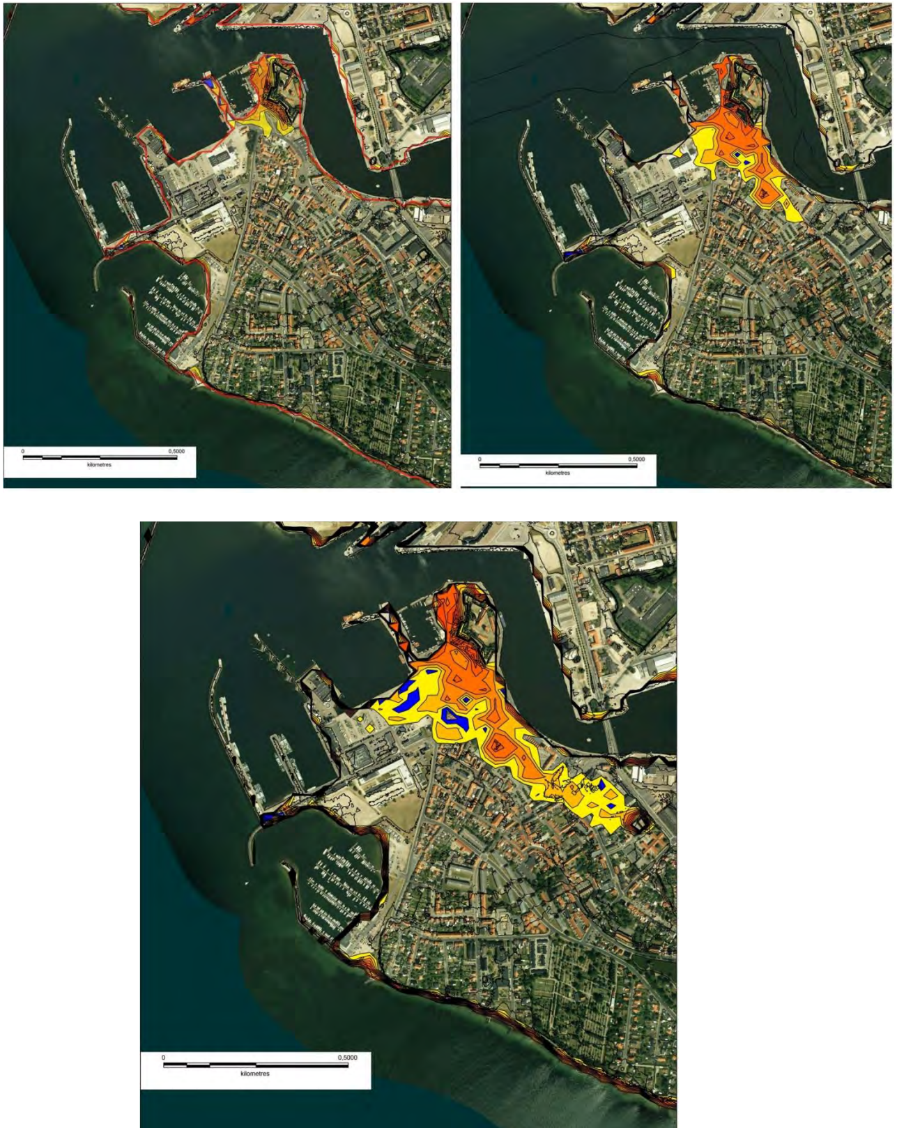
Figur 2.3: Oversvømmelsen fra 2006 i tre tidsstep. Første billede er klokken 18.40 andet er 20.40 og den højeste vandstand er taget klokken 22.40.
