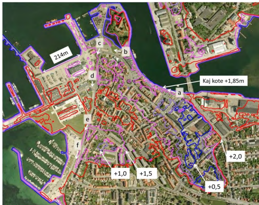
Figur 9.1: Højdekort over Korsør by. Højdekurver: Blå: +0,5m; Violet: +1,0m; Lilla: +1,5m; Rød: +2,0m. Alle koter er i DVR90. Bogstaverne "a" til "f" angiver hvor billederne er taget og pilen angiver retningen.
