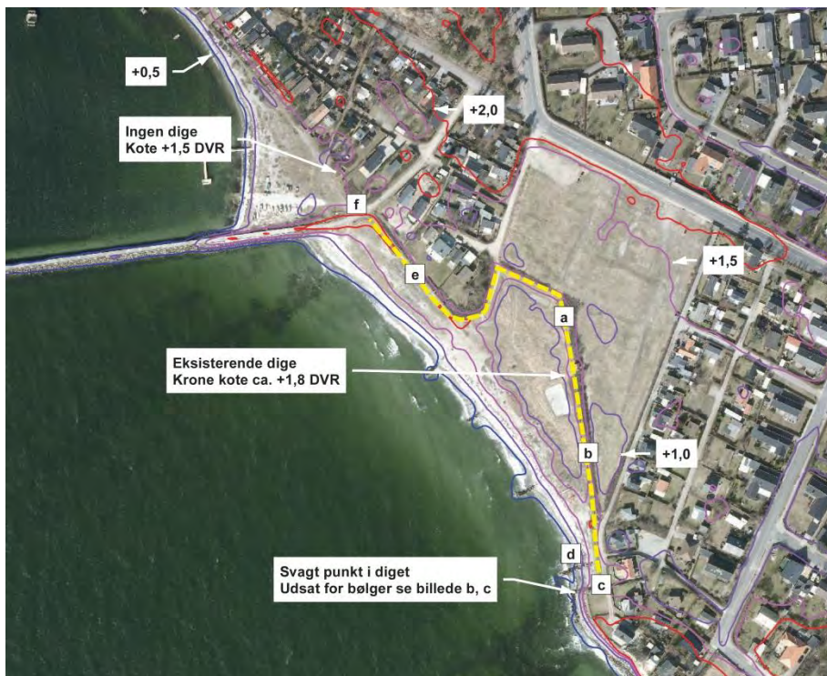
Figur 6.1: Placeringen af Område 1: Granskov er vist på øverste oversigt figur; eksisterende kystbeskyttelse med dige er vist på figuren nedenfor med gul stiplede linie. Højdekurver: Blå +0,5 m; Violet: +1,0 m; Lilla: +1,5 m; Rød: +2,0 m. Alle koter i DVR90.
