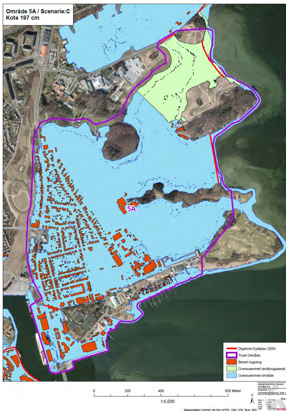
Figur 10.6: Oversvømmelse af område 5A . Vandstandshændelse C: +197cm DVR 90. Antallet af oversvømmede ejendomme er fordelt på bygningstyper og ejerforhold.
