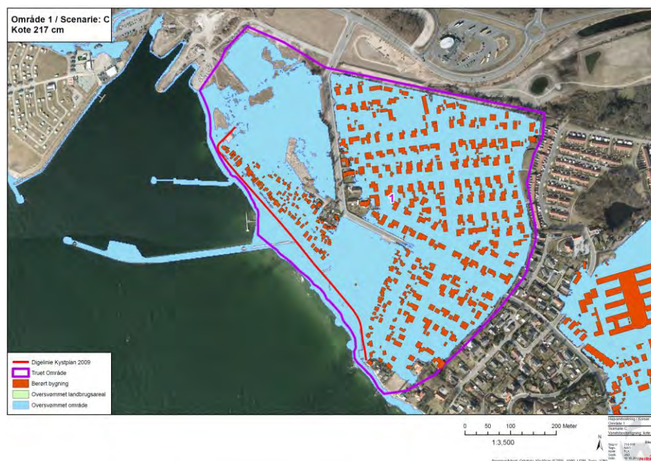
Figur 6.4: Oversvømmelse af Område 1: Granskoven for vandstandshændelse C: +217 cm DVR90.
