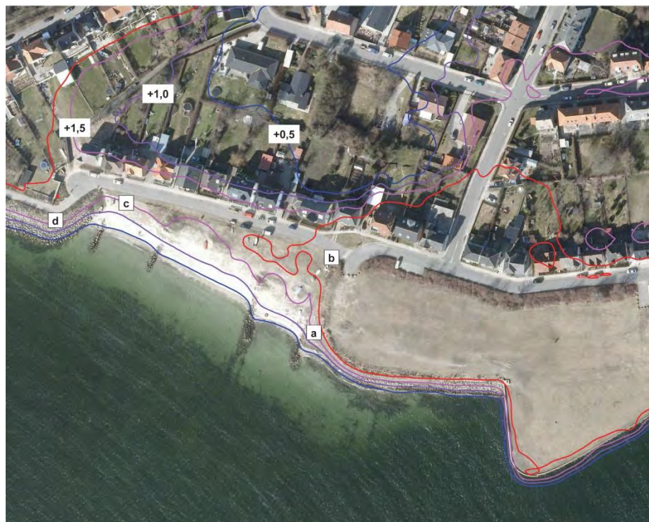
Figur 8.1: Placeringen af Område 3: Strandvejen er vist på øverste over-sigtsskema, mens områdets topografi er vist på figuren nedenfor med højdekurver: Blå +0,5 m; Violet: +1,0 m; Lilla: +1,5 m; Rød: +2,0 m. Alle koter i DVR90. Position for foto er vist.
