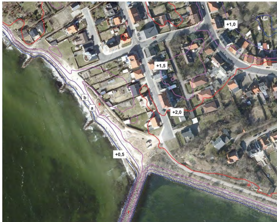
Figur 7.1: Placeringen af Område 2: Jægersvej-Søvænget-Værftet er vist øverst, mens den nederste figur viser topografiske forhold langs kysten. Højdekurver: Blå +0,5 m; Violet: +1,0 m; Lilla: +1,5 m; Rød: +2,0m. Alle koter i DVR90. Placering af foto er vist.
