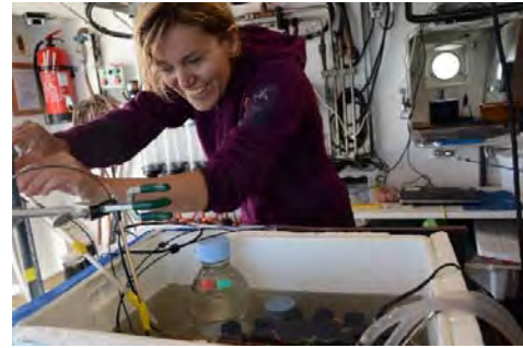
Måling af iltforbrug i sediment og vandsøjle i vådlaboratoriet ombord på Aarhus Universitets forskningsskib AURORA. Foto: Kite Linding Gerlich.
