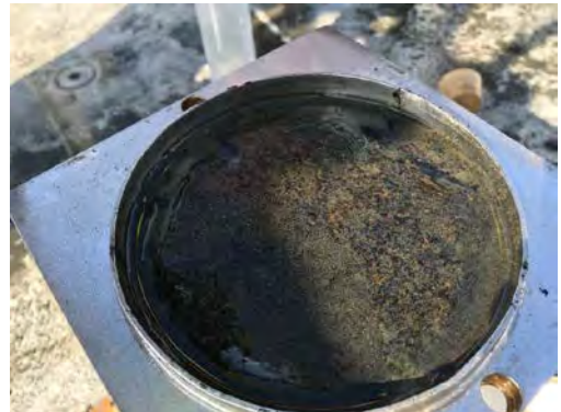
Hapsprøve af sediment der er påvirket af iltvind. Reduceret jern i form af sort jernsulfid (FeS) er synligt i overfladen af sedimentet. Foto: Signe Høgslund.
