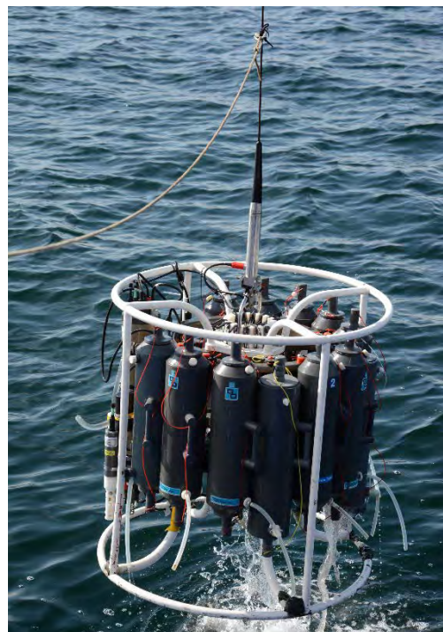
Rosette monteret med vandhentere og sensorer til indsamling af vandprøver og måling af fysisk-kemiske profiler i vandsøjlen.
