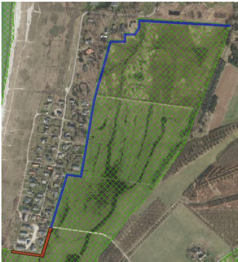
Figur 12-19 Det potentielt påvirkede område for løsningsforslaget, Saltengen 4. Figuren viser udbredelsen af Natura 2000-område N162 omkring Kobæk Sønderstand (grøn skravering). Den røde markering angiver den estimerede permanente arealinddragelse i Natura 2000-området. Den blå markering angiver hvor der etableres en spunsvæg.
