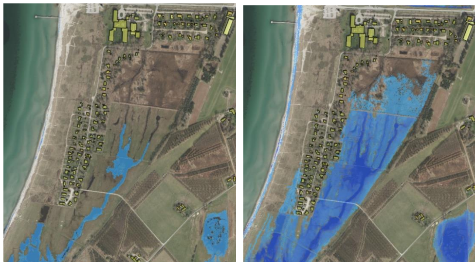
Figur 12-20 TV: permanent vandspejl i 2070, TH: permanent vandspejl i 2100. Udviklingen som følge af ændringerne i klimaet og dermed stigende middelvandspejl vil på sigt bevirke at området vil blive "opslugt" af det marine territorie og de i dag eksisterende naturtyper vil forsvinde i den form de har i dag.
